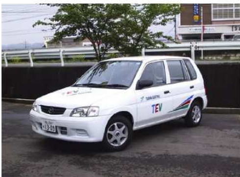
電気自動車 (KING FISHER) 特長 誘導モータ使用 一充電で100km走行、100km/h
